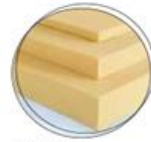
PUR/PIR (Espuma Rígida de Poliuretano ou de Poli-isocianurato). condutibilidade: 0,040
