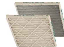
Exemplo de dois filtros de um sistema de climatização (colmatado e limpo)
